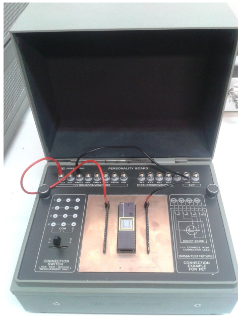
Figura 4.5 – PCB acabada con uno de los dispositivos conectados en el 16058A Test Fixture.
