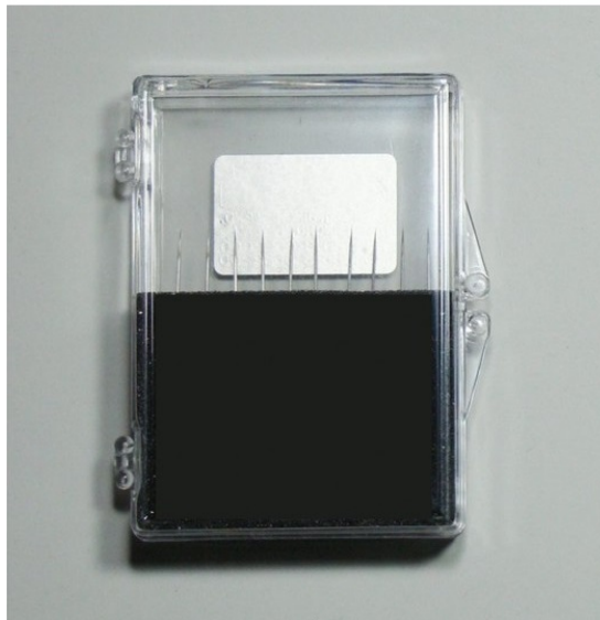
Figura 3.41 – Agujas de contacto (Puntas).
