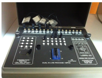
Figura 3.23 – Zócalo y cables de conexión del Test Fixture.
