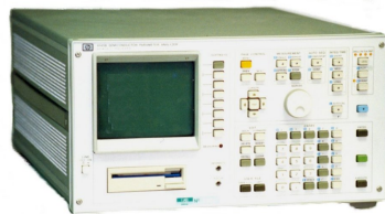
Figura 3.16 – Analizador de parámetros HP 4145B [6].
