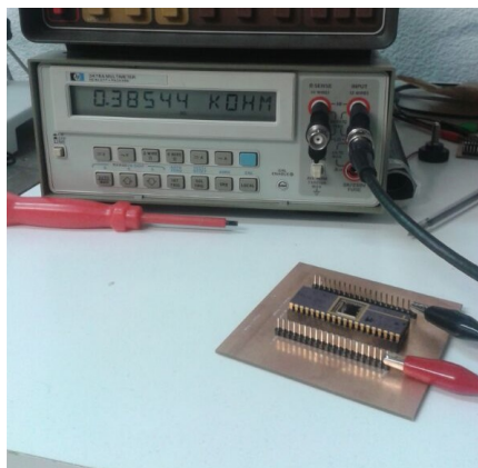
Figura 5.6 – Medida de la resistencia de un dispositivo roto.
