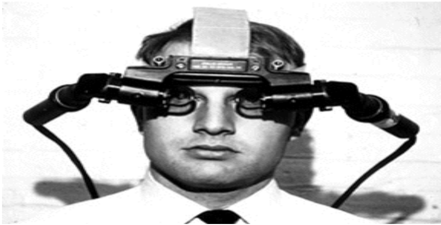
Fig. 8. Head Mounted Display , modelo diseñado y programado por Ivan Sutherland. Fuente: http://blog.rtve.es/webdocs/2014/12/la-realidad-virtual-como-afectar%C3%A1-a-los-webdocs-parte-3.html
