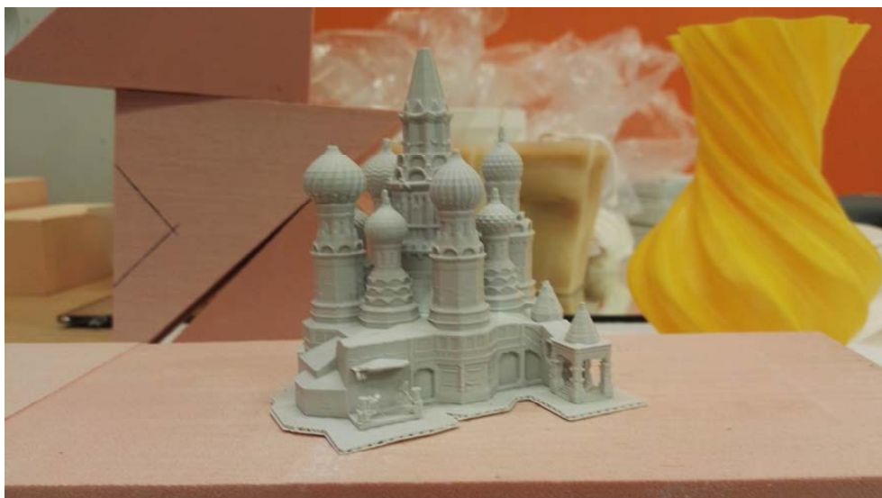
Fig. 26. Prototipo de un edificio de la Plaza Roja de Moscú realizado en Politécnico di Milano, demuestra la capacidad de la impresión 3D para imprimir modelos físicos con detalles muy precisos. Imagen del autor 2016.
