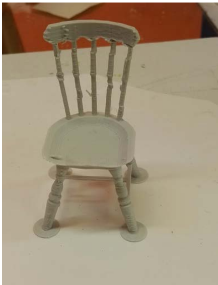
Fig. 30. Un prototipo de una silla realizada en los laboratorios de impresión 3D en Politecnico di Milano, durante la estancia del autor, demuestra la capacidad de esa técnica de producir ejemplos que simulan los muebles originales al detalle. Imagen del autor.
