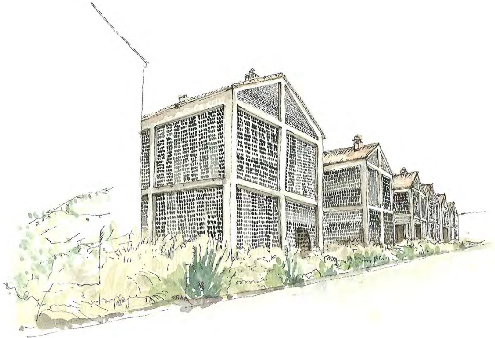
Acuarela y plumilla. Conjunto de secaderos con revestimiento de piezas de hormigón en masa en Chaparral
