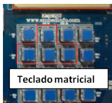
Figura 5. Teclado matricial para los movimientos
