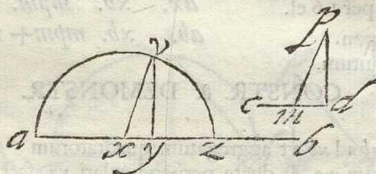
*prop. 7. Introd.* Sit aggregatum data recta  $ab$ , & ratio data  $dp$  ad  $cd$ . Sint quæsiæ partes  $ay$ .  $zb$ .  $yz$  quo posito, si recta  $az$  bisecta supponatur in  $x$ : erit  $xy$  differentia extremarum, & descripto semicirculo  $avz$ , erectaque perpendiculari  $yv$ : erit ipsa recta  $zb$  æqualis. Ergo si iungatur  $xv$  perspicuum erit ex terminis rationis datae triangulum posse fieri, cui simile debeat esse  $xvy$ .
