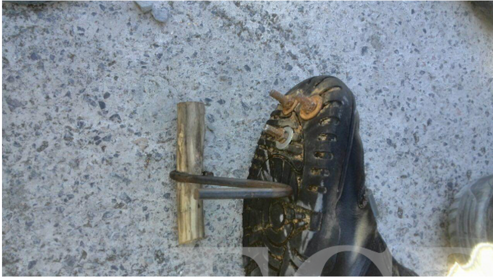
Ilustración 22. Herramientas utilizadas para sortear la malla antitrepa instalada. Fuente: http://www.elconfidencialdigital.com/seguridad/nueva-bota-garfio-saltar-valla-Melilla_0_2511348864.html
