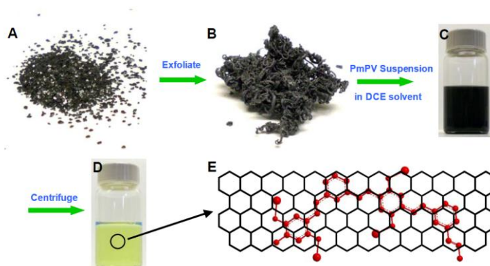
Figura 28. Esquema del proceso de fabricación de una suspensión que contiene GNRs. a) Grafito expandible comercial; b) grafito exfoliado térmicamente; c) suspensión uniforme; d) sobrenadante tras el centrifugado; e) dibujo esquemático de un nanoribbon de grafeno con dos unidades adsorbidas de PmPV sobre su superficie.
