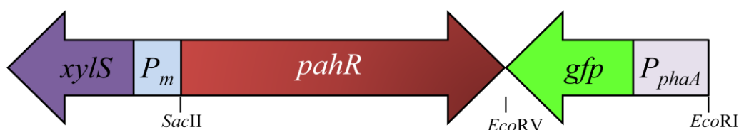
Figura 7. Esquema del sistema bioreportero pKSPA-4 para la detección de PAHs en sistemas heterólogos.
