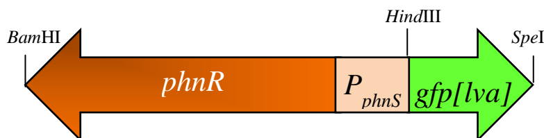
Figura 4. Esquema del sistema bioreportero pKSN-2 de naftaleno y derivados con GFP inestable.
