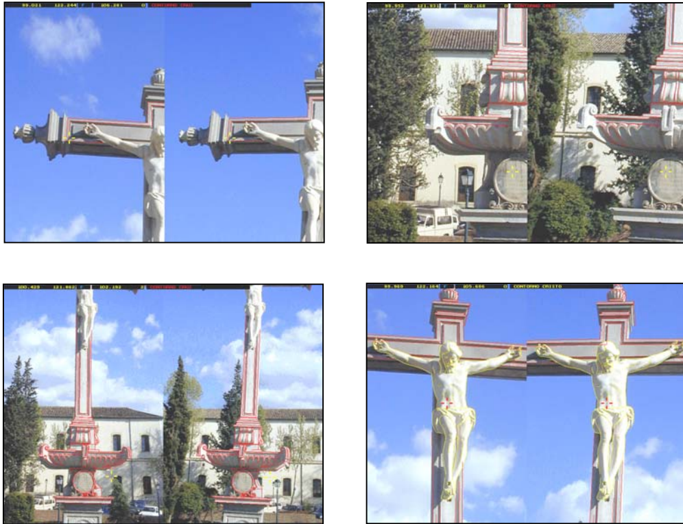
4.42. Una restitución estereofotogramétrica. Delineado tridimensional.
