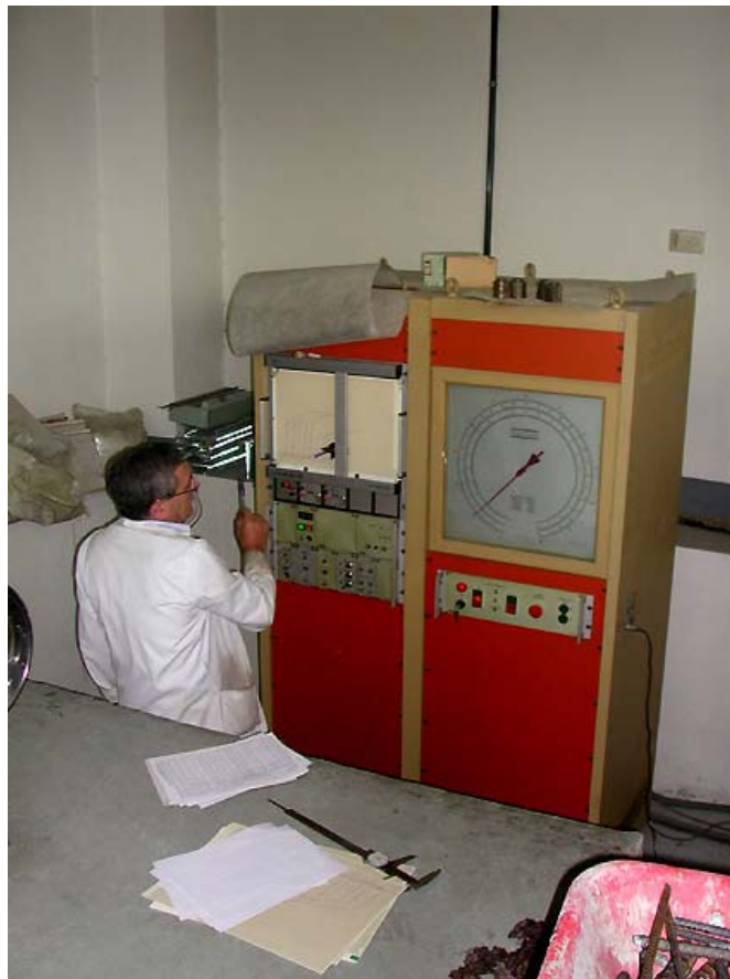
6.99. La arquitectura como marco funcional: Representación fotográfica de los útiles empleados en las distintas fases de una actividad (ensayo a tracción de redondos de acero para la construcción).
