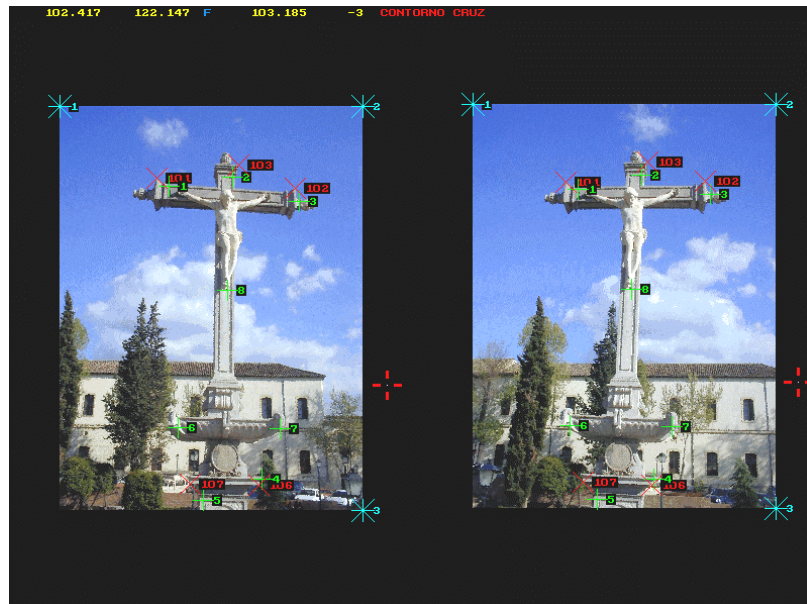
4.41. Interface del programa de estereorrestitución Video Estéreo Digitalizador (VSD) de AGH. Orientación relativa mediante los puntos de control.
