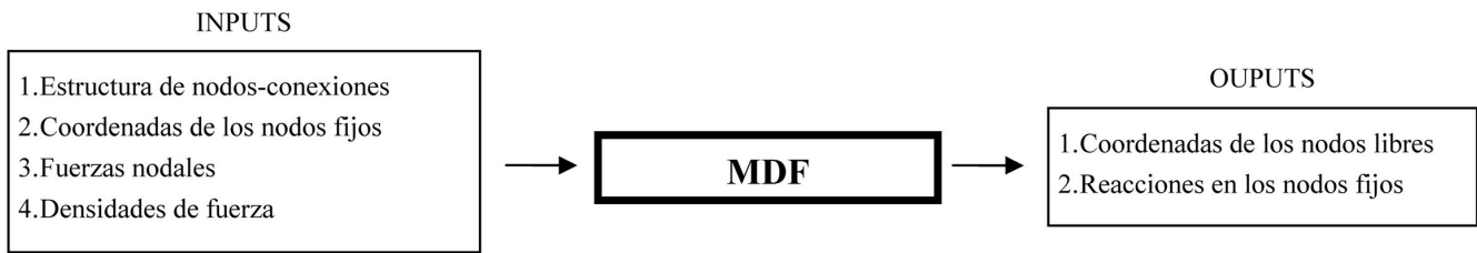
Figura 2. Esquema de INPUTS - OUTPUTS en el MDF.
