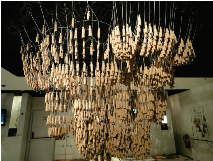
Figura 1.46: Maqueta funicular de Gaudí expuesta en el Centre Reus (Tarragona)
