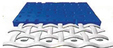
Figura 1.27: Estructura del PES-PVC
