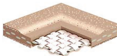
Figura 1.28: Estructura de la fibra de vidrio recubierta de PTFE
