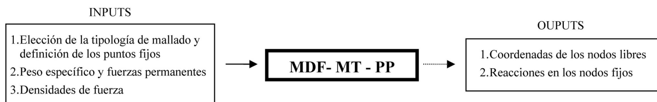
Figura 4. Esquema de inputs - outputs en el MDF-MT-PP.
