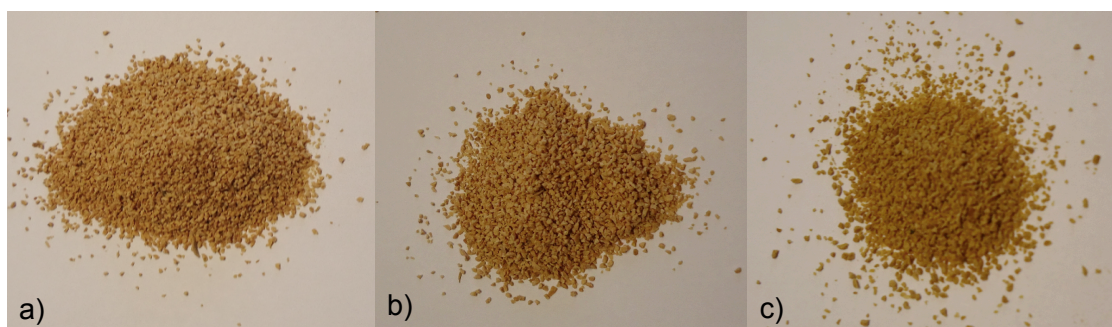
Figura 3.1: Aspecto del hueso de aceituna tras ser tratado con a) H 2 SO 4 2 M, b) HNO 3 2 M y c) NaOH 2 M.
