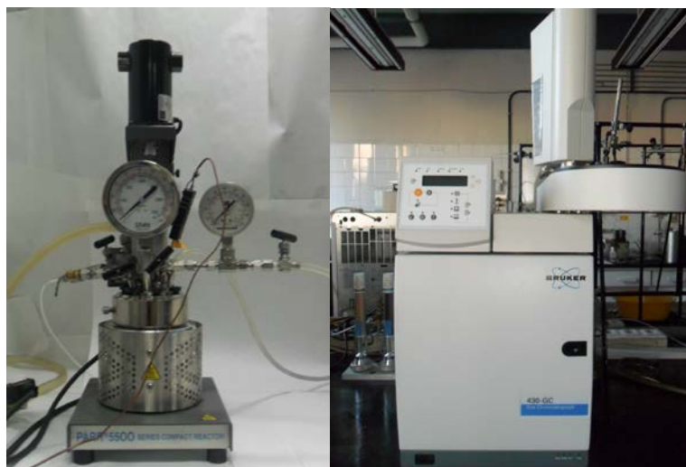
Figura 2.3. a) Reactor de alta presión empleado en la reacción de hidrogenación de citral. b) Cromatógrafo de gases para la identificación de los productos de reacción.
