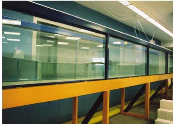
Figura 3.4.2 Canal de oleaje corriente. Centro CEAMA-UGR
