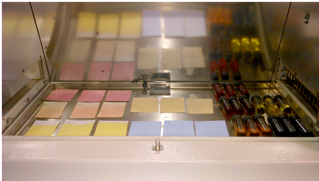
Figura 2.1: Situación de las muestras en el interior de la cámara de envejecimiento.
