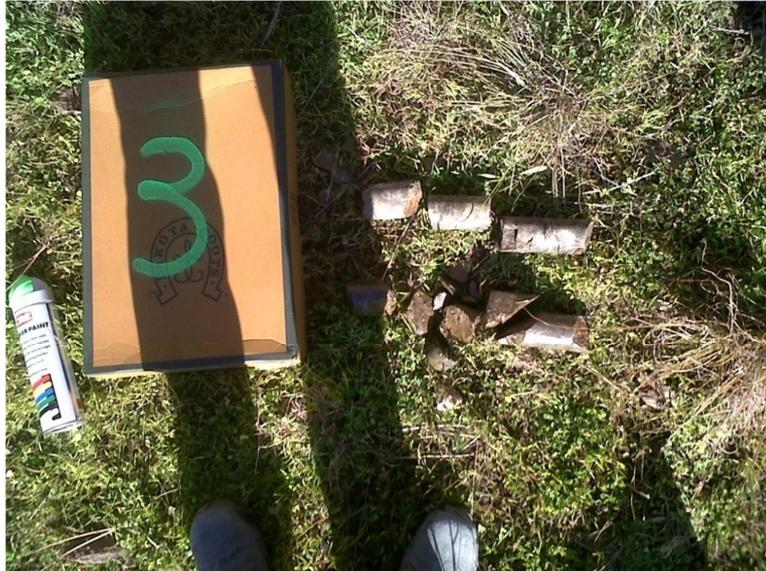
**Ilustración 2.23** Testigos de micaesquisto extraído en campo, de los taludes analizados, a diferentes profundidades; en la imagen superior se trata de uno de los testigos extraído en la zona-punto número 3.
