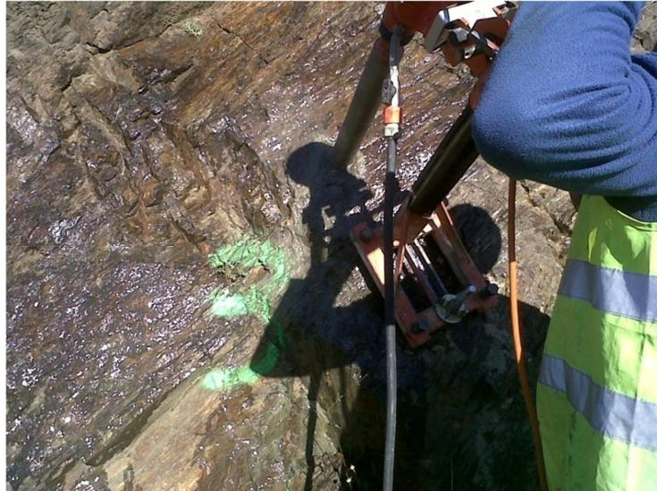
**Ilustración 2.21** Extracción in situ de testigos de los taludes estudiados, concretamente el punto n° 3
