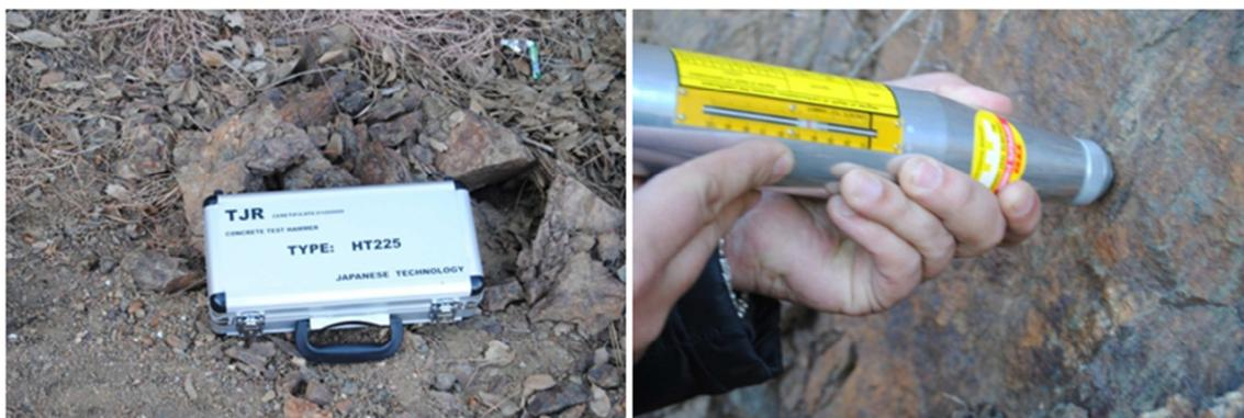
*Ilustración 2.20* Equipo martillo Schmidt, utilizado en las labores de campo efectuadas en los taludes inventariados.
