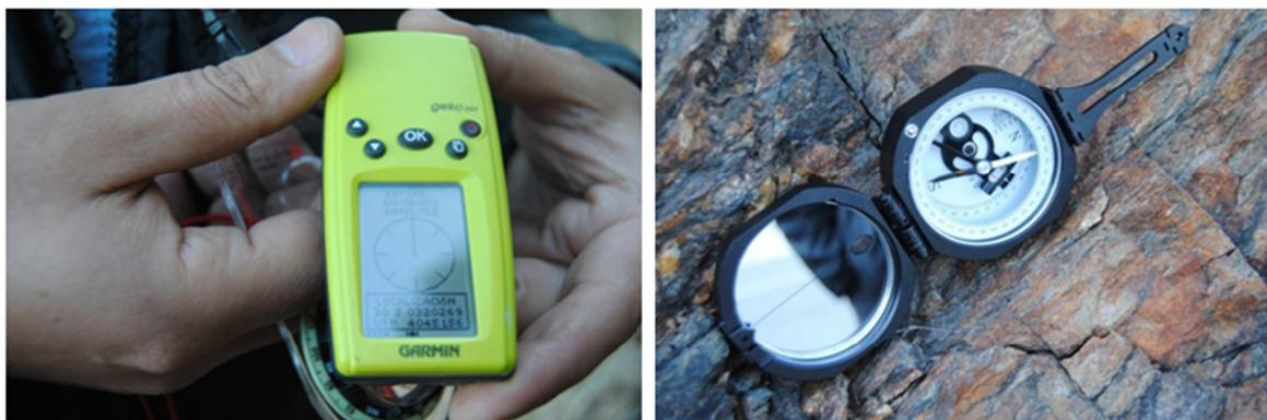
*Ilustración 2.17* Dispositivo GPS GEKO-201 y brújula geológica MODEL DQY-1, utilizados en el estudio de taludes de este trabajo.
