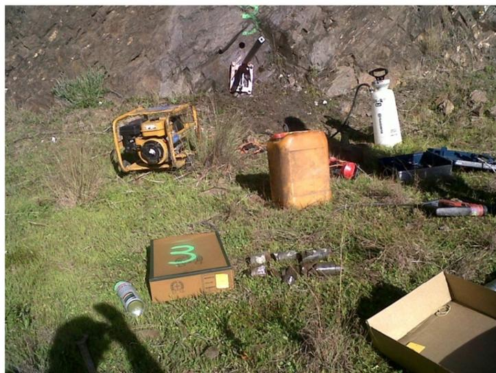
**Ilustración 2.24** Imagen de la instrumentación utilizada para la extracción de los testigos in situ, en los taludes inventariados.
