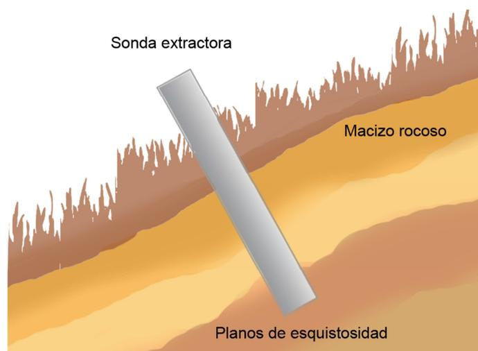
**Ilustración 2.22** Esquema de sistema de extracción in situ de las muestras de la matriz rocosa en el macizo de esquistos mediante la sonda extractora y taladradora Hilti DD-130..
