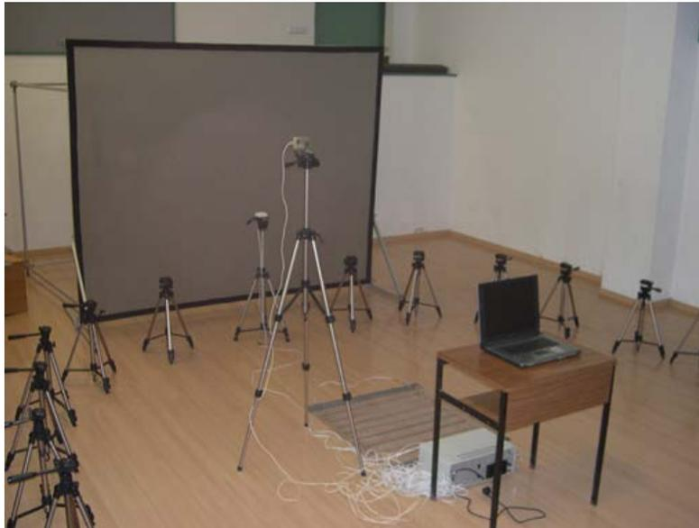
**Figura 1.** Sistema "Pheripherix" para la evaluación de la respuesta de reacción ante estímulos visuales (luminosos y/o figuras geométricas) y sonoros
