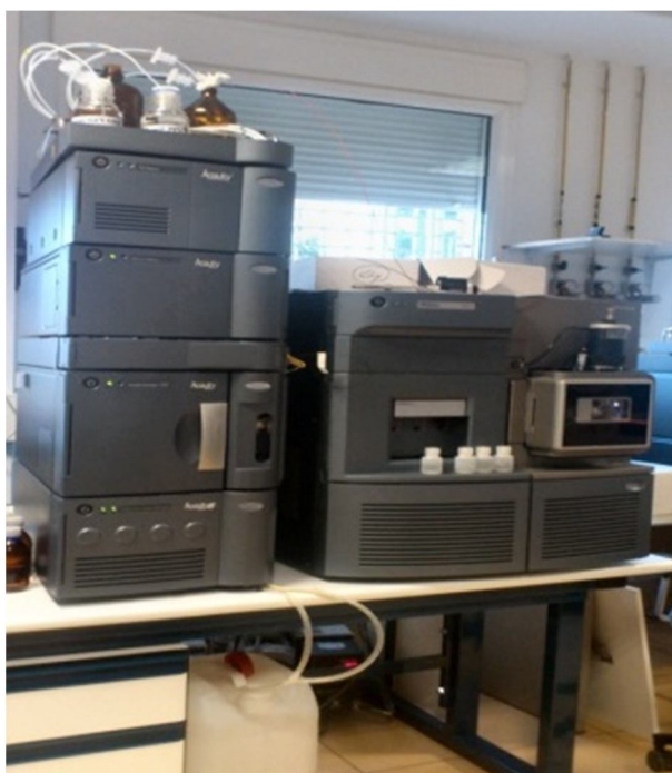
Figura I.1. Equipos de cromatografía de líquidos acoplado a espectrometría de masas empleado. Cromatógrafo Waters Acquity UPLC™ H-Class–Xevo TQSM™
