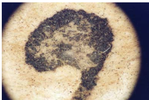
Figura 29. Desprendimiento de la tinta de carbón. Manuscrito L-14029. f. 63, AHPM (Archivo de T. Espejo).
