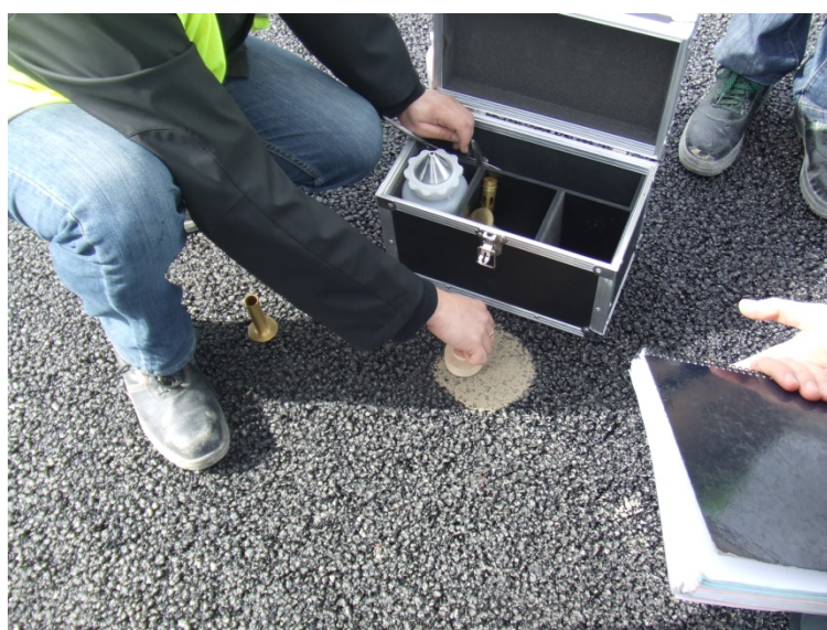
Foto 35. Ensayo de círculo de arena para la medida de la macrotextura.
