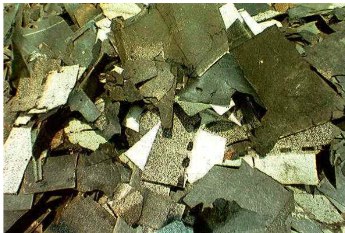
Foto 10. Residuos de Cubiertas de asfalto.
