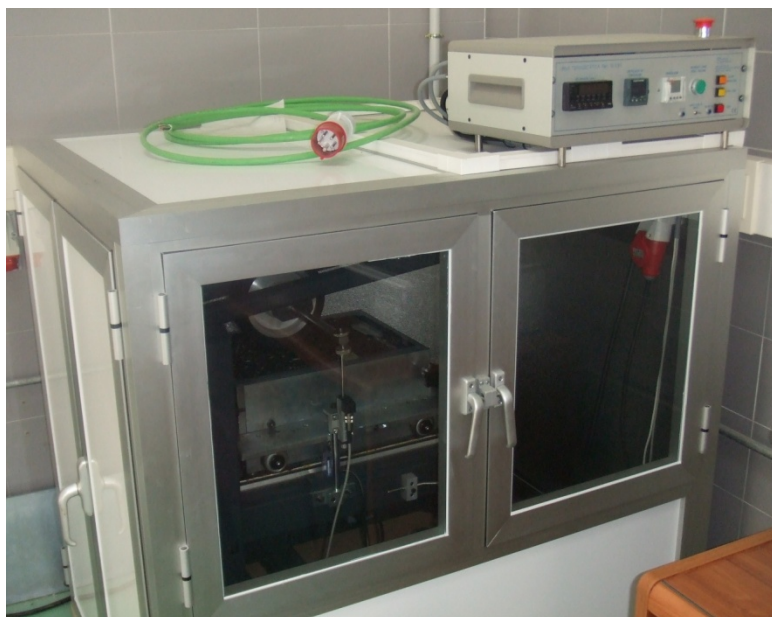
Foto 29. Máquina Wheel Tracking utilizada en el ensayo de pista.
