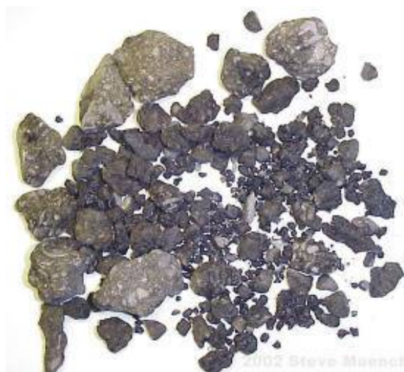
Foto 2. Material fresado de capas de firme.
