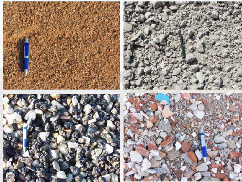
Foto 6. RCD como áridos reciclados [65].
