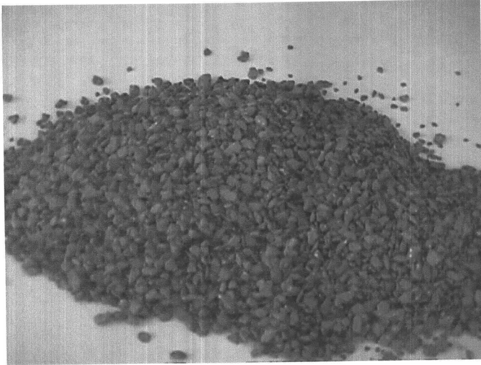
Figura V.2. Relleno cerámico empleado en las plantas a escala de laboratorio.
