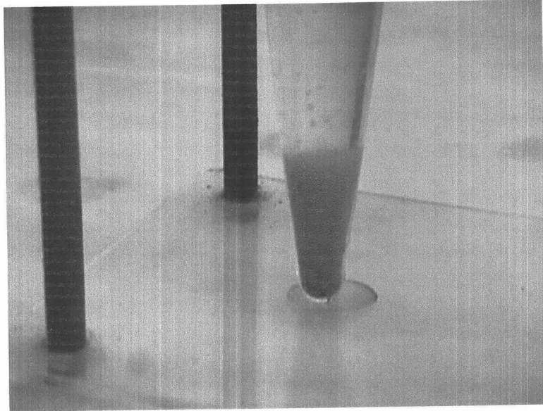
Figura V.11. Ensayo de sedimentación del agua de salida de la planta tras realizar el lavado, sin previa formación de biopelícula.
