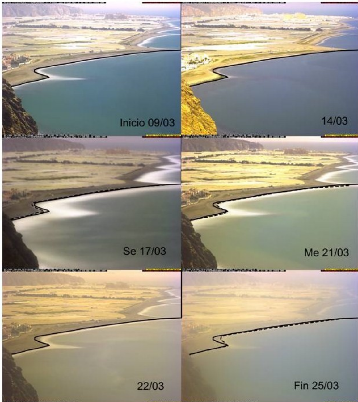
Figura 5.11: Selección de imágenes de los días más representativos de la tormenta C03-t2. La línea continua representa la posición inicial de la línea de costa. La línea discontinua representa la línea de costa en ese instante.
