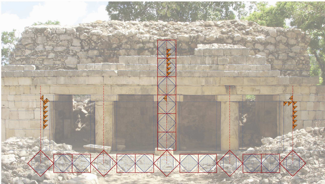
Ilustración 123. Modulación del alzado del edificio sur del grupo inicial de Xcalumkin
