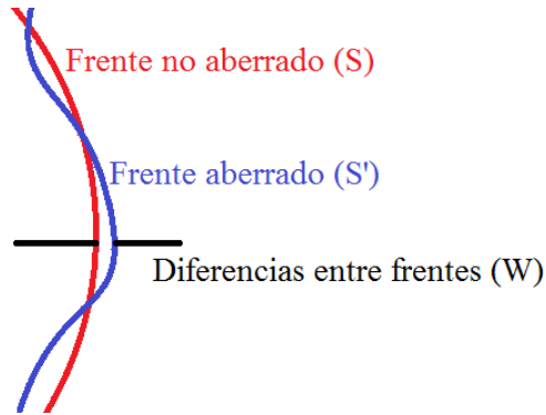
Figura 2.9 Representación de un frente teórico S (no aberrado) y el mismo frente pero real S' (con aberraciones). Las diferencias entre ambos forma el denominado frente de aberraciones.
