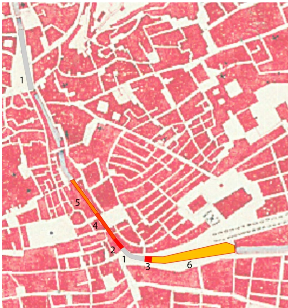
Fig. 59. Cubrimientos del Darro hasta 1868, indicados sobre un fragmento de la hoja n°8 del Plano de Granada de José Alcántara y Sebastián de la Torre, versión 1868. 1: tramos ejecutados de Plaza Nueva y Puerta Real (antes de 1836); 2: tramo Puerta Real- Carmen (primera fase, 1836); 3: ampliación de Puerta Real (1850); 4: tramo Puerta Real- Carmen (segunda fase, 1854); 4: tramo Carmen-puente del Carbón (primera fase, 1857); 5: tramo zona del Carmen-puente del Carbón (segunda fase, 1858); 6: tramo Puerta Real-puente de Castañeda (1866-1868).
