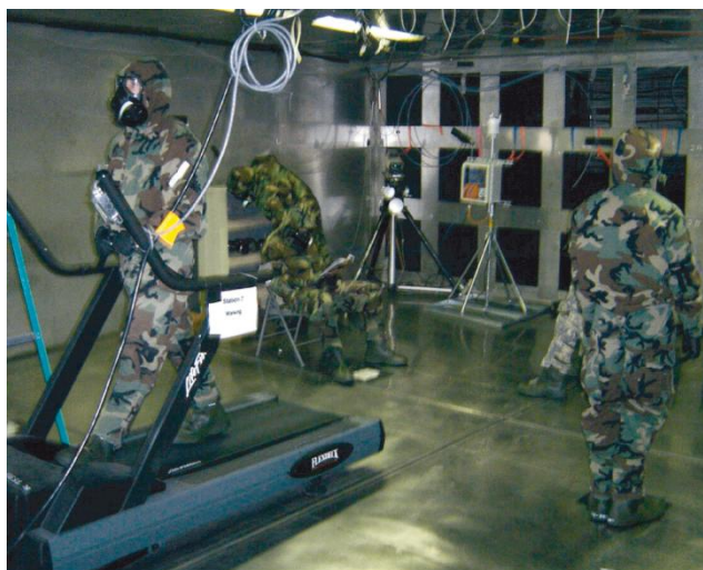
Figura 2.8. Pruebas de simulación de tejidos y máscaras de gas para la protección frente a compuestos químicos tóxicos. (Fuente: Charles Walker, Dugway Proving Ground, U.S. Department of Defense). 6
