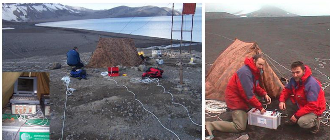
Figura 3.4 Instalación de una antena sísmica en Bahía Fumarolas. En el margen inferior izquierdo de la foto izquierda se observa el sistema de adquisición de datos junto con el PC de registro.
