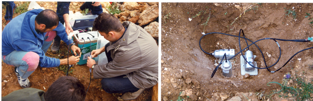
Figura 2.6. Instalación de la estación portátil PLL para el registro de la serie de Iznájar.
