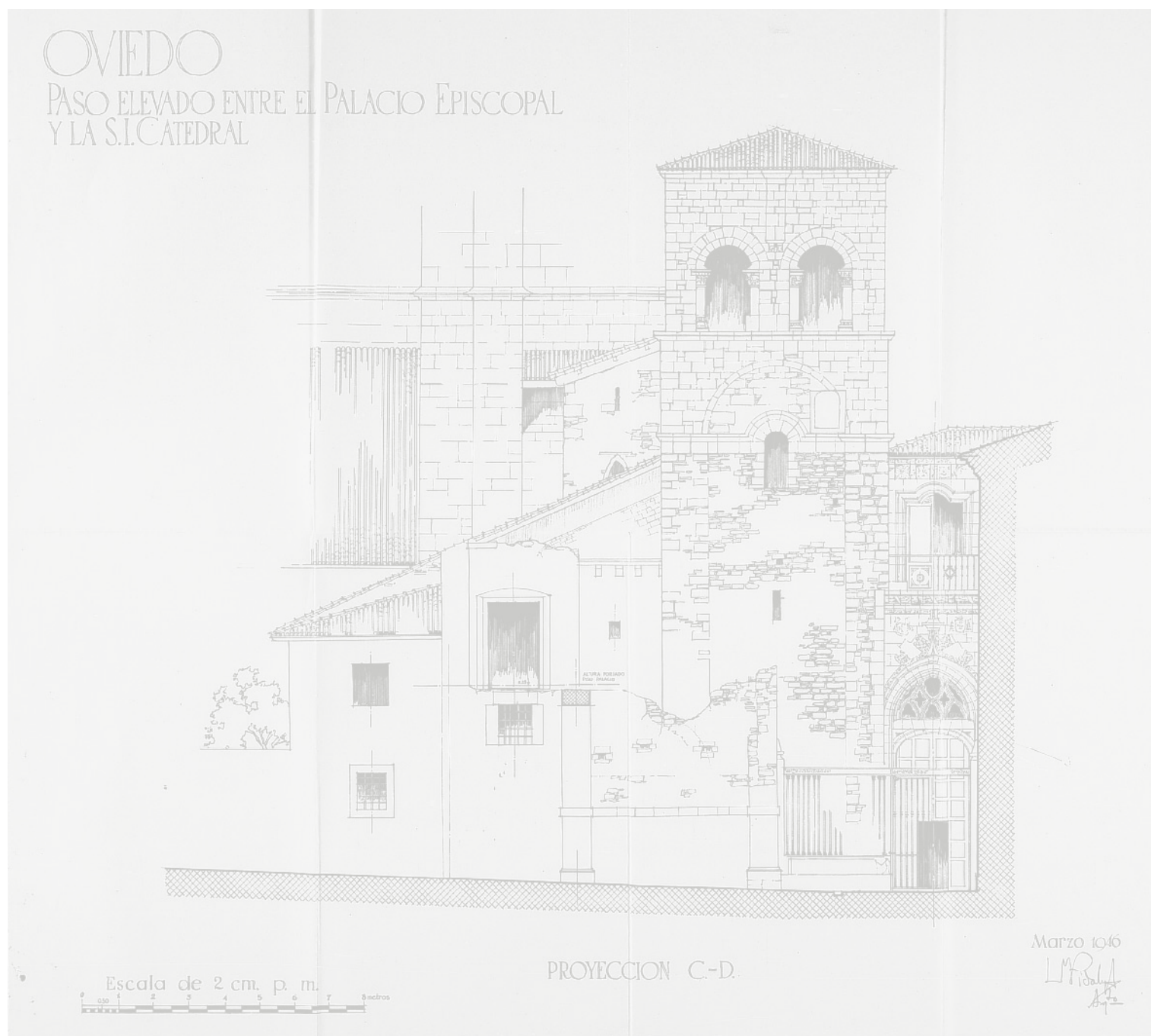
La torre Vieja de la catedral de Oviedo. Estado previo tras la demolición del paso elevado, Luis Menéndez-Pidal
