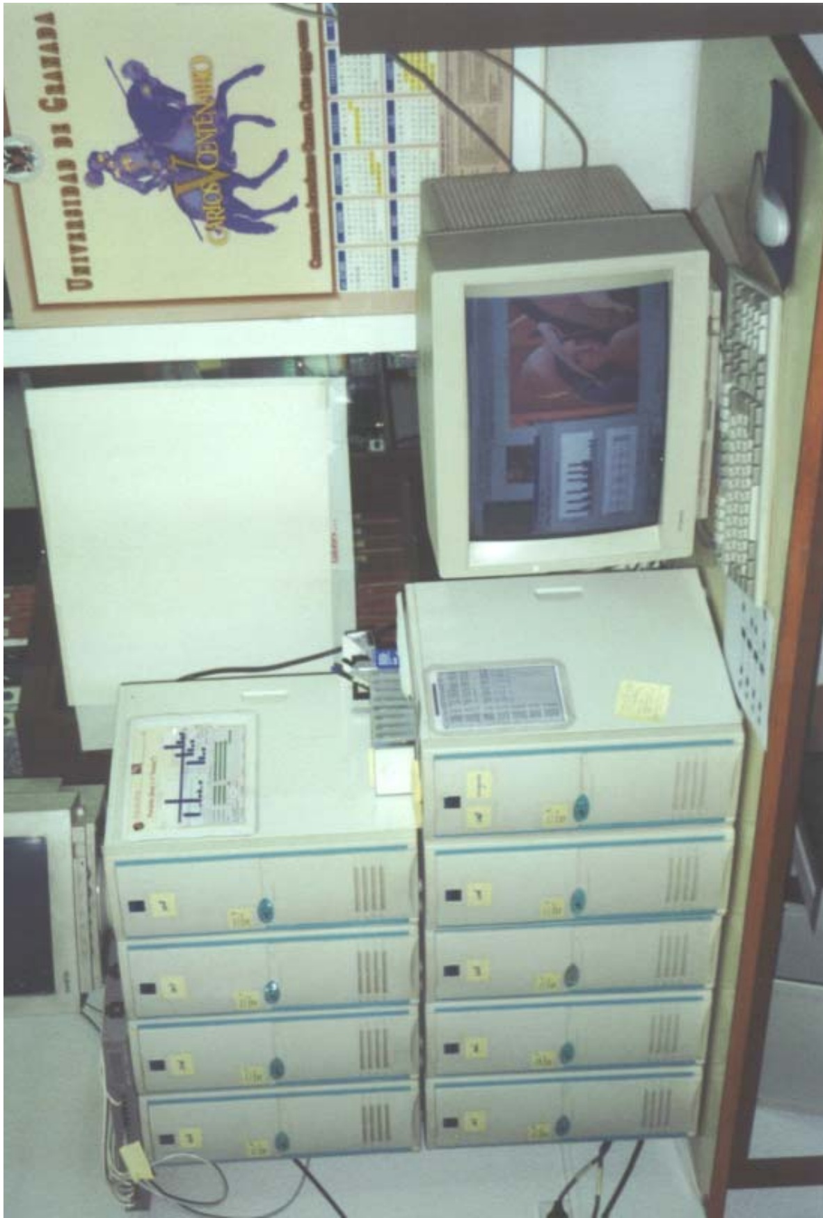
Figura 2.1: Fotografía del cluster utilizado para esta memoria, “oxígeno”. Consta de 8 clientes Pentium II (ox5-8 apilados, ox1-4 en la base) y un servidor de disco (ox0) con ratón, teclado y monitor, accesible desde el exterior (a la derecha, con el calendario de las copias de seguridad que se ven encima). El monitor apilado está conectado a ox5, encima del cual se ve el switch BayStack 350T.
