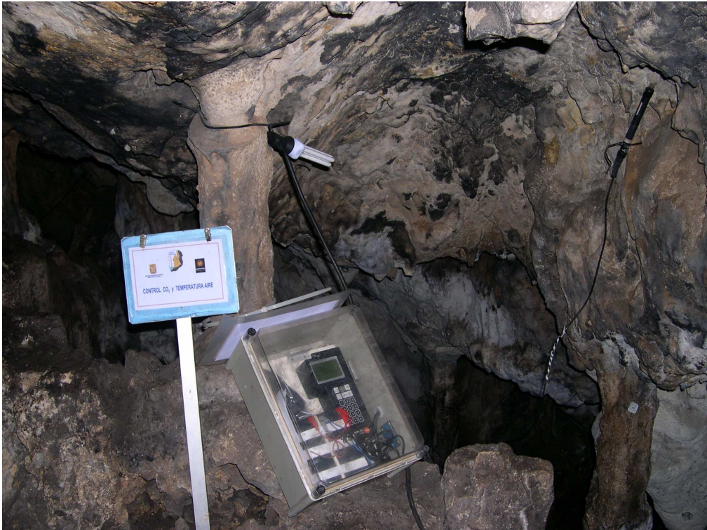
Figura 9: “Data-loggers” para la recogida de datos de temperatura y humedad del aire, localizados en el Pasillo de las Columnas.
