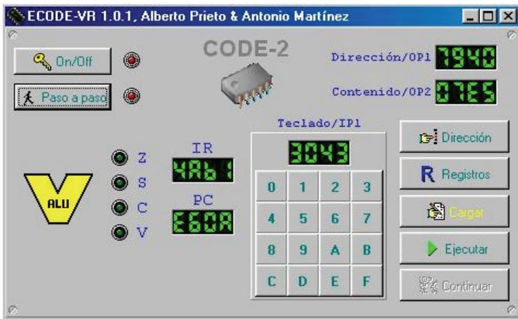
Figura 1. Simulador básico de CODE-2
