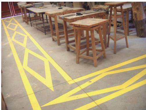
*Imagen 5, señalización horizontal de evacuación.*
