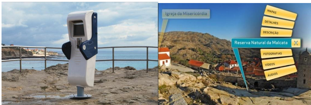
Ilustración 5. Virtual Sightseeing instalado en Centro de Interpretación Medioambiental de Ponta do Sal (Lisboa) e imágenes del display con información aumentada que aparece sobre los diferentes puntos de interés (YDreams, 2010).
