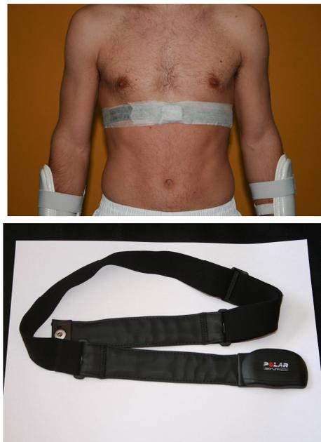
Figura 2.4.5.2. Fijación de Banda emisora
