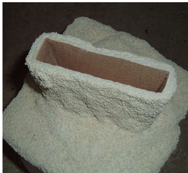
Fig. 211 3º. Aspecto final del molde cocido
