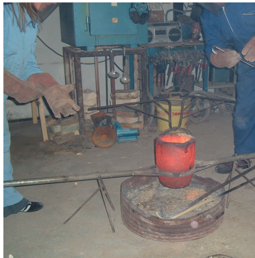
Fig. 213 Preparación del crisol para la colada
