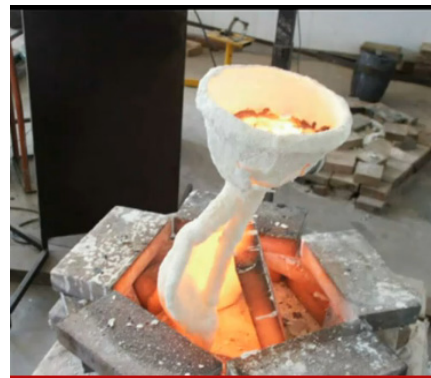
Baños cerámicos del conjunto y estucado
