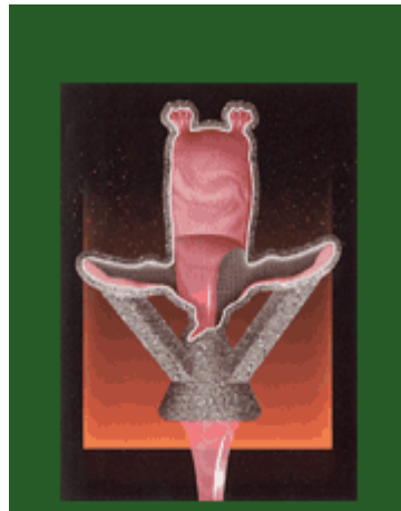
3. Molde dentro del horno para derretir la cera
