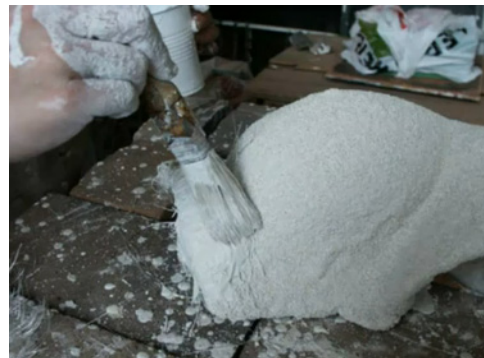
Retoque del molde con fibra de vidrio
