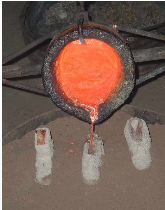
Fig. 217 Detalle del vertido del bronce en el interior de los moldes
