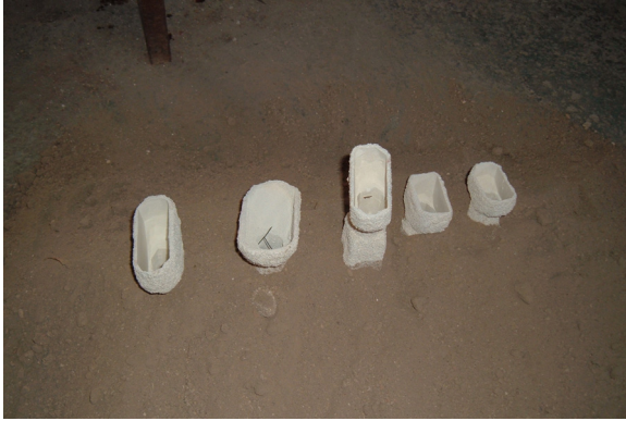
Fig. 212 Lecho de arena con las piezas preparadas para la colada del metal.
