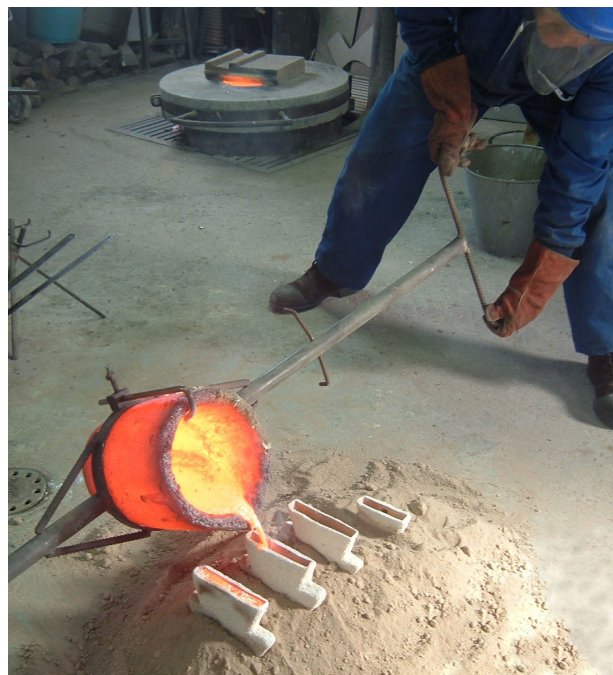
Fig. 216 Vertido del bronce en el interior de los moldes
