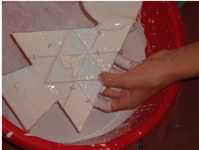
Fig. 190 Aplicación de la barbotina..
