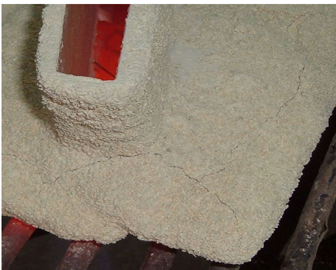
Fig. 196 Grietas en el molde después de la cocción.
