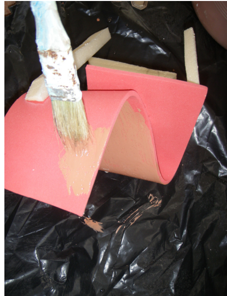
Fig. 188 Pintura refractaria sobre el modelo
