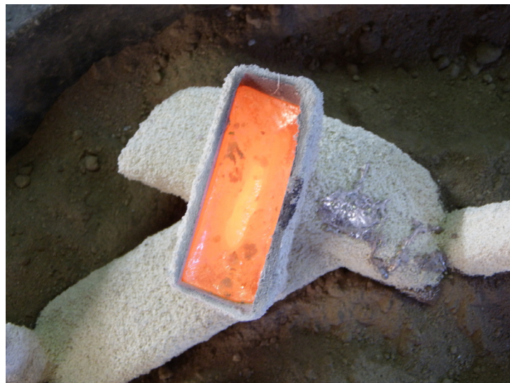
Fig. 219 y 220 Rechupes en la zona de entrada.
