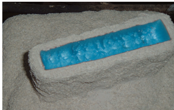
Fig. 206 El modelo se gasifica desprendiendo gas
