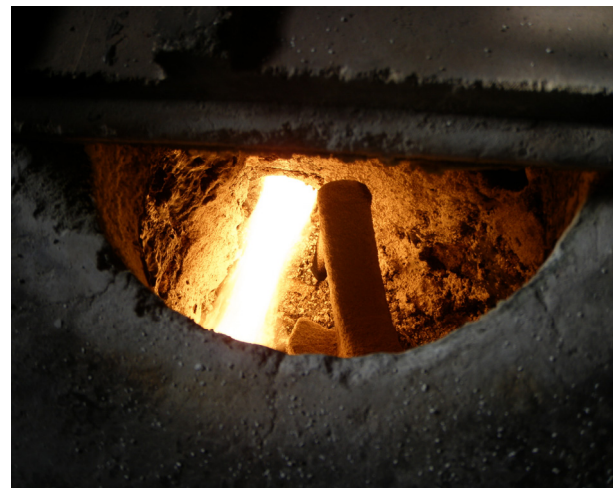
Fig. 202 Cocción del molde en horno
