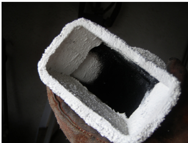
Fig. 203 Restos carbonizados en el interior del molde tras la cocción en la campana
