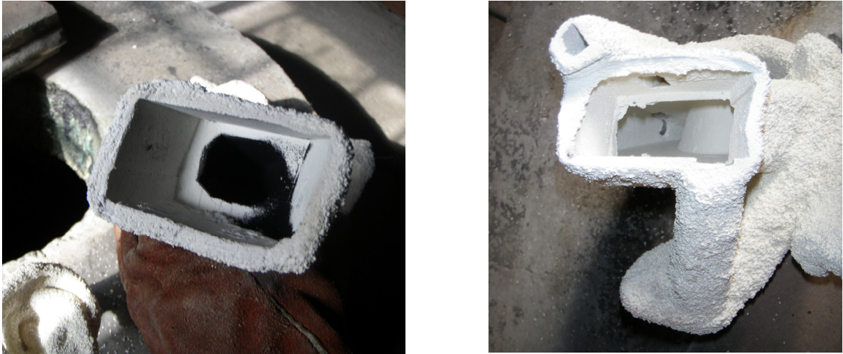
Fig. 204 y 205 Evolución de la gasificación del modelo de EVA (goma eva). Limpieza del molde tras la cocción en el horno
