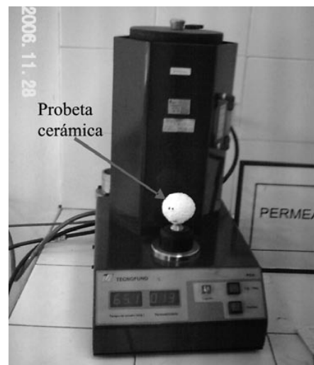
Fig. 175 Permeámetro digital para pruebas de cáscaras cerámicas
