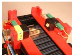
Figura 6.4: Fototransistor colocado en la cinta transportadora
