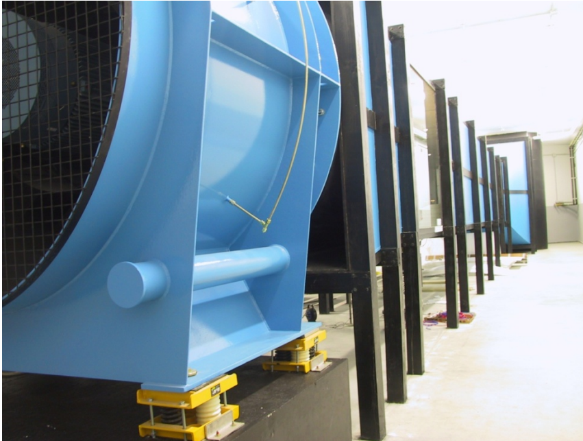
Figura 2.2-2 Exterior del túnel de viento de capa límite
