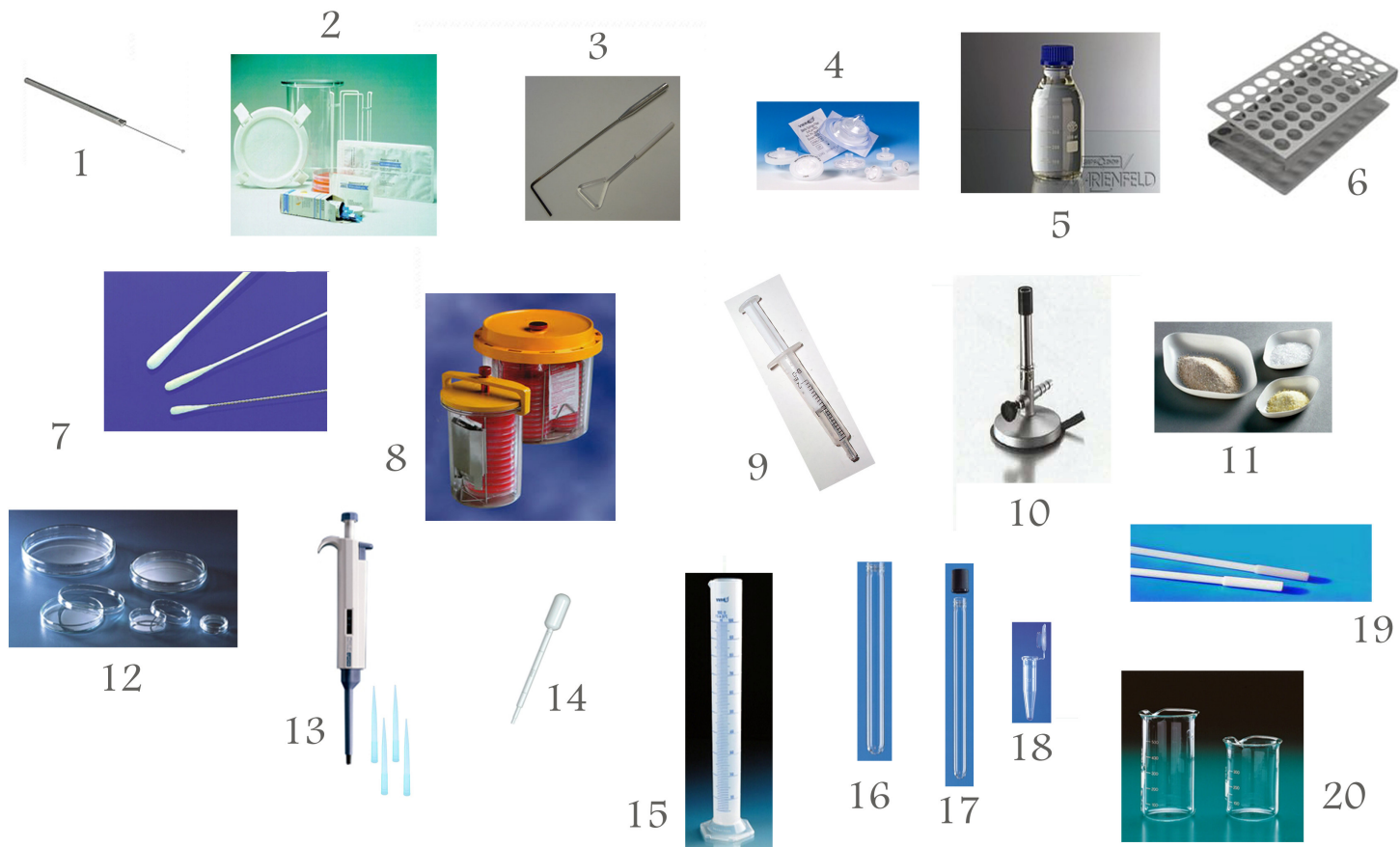
Fotografía 3. Material de laboratorio – Plan de trabajo microbiología: 1. Asa de platino. 2. Anaerocult A. 3. Espátula de Digralsky. 4. Filtro para jeringa. 5. Frasco de vidrio. 6. Gradilla de aluminio. 7. Hisopo. 8. Jarra de anaerobiosis. 9. Jeringa. 10. Mechero Bunsen. 11. Navecillas de pesaje. 12. Placas Petri. 13. Pipeta automática. 14. Pipeta Pasteur. 15. Probeta. 16. Tubo de ensayo. 17. Tubo de ensayo con tapón. 18. Tubo Eppendorf. 19. Varilla magnética. 20. Vaso de precipitado.
