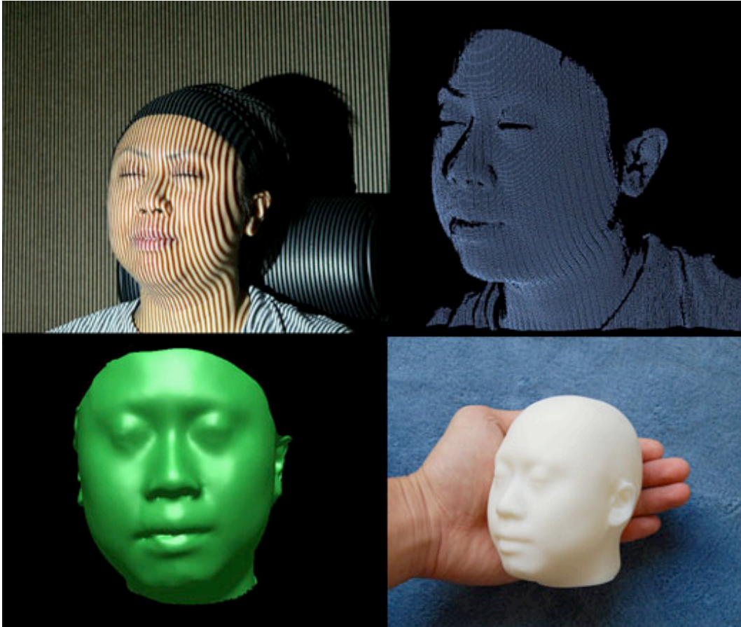
Figura 15. Modelado con scanner 3D.
