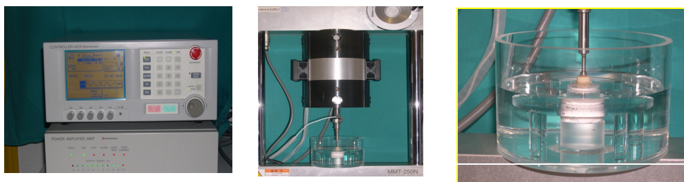
Fig.5. Las muestras fueron sometidas a un proceso de ciclado mecánico durante el cual, la interfaz creada estaba sumergida en agua.
