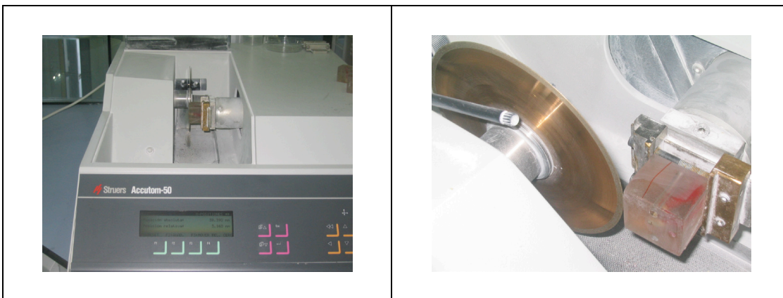
Figura 26. Máquina de corte automático Accutom-50 en donde se realizaron los cortes transversales de los especímenes.
