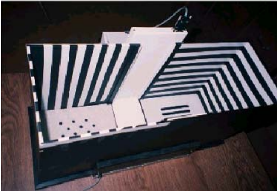
Figura 5. Laberinto en corredor para el condicionamiento de preferencias por un lugar (CPP).
