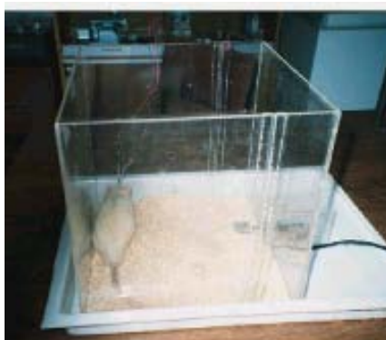
Figura 33. Fotografía de una rata Wistar en la una caja de Skinner para autoestimulación eléctrica intracerebral (AEIC).
