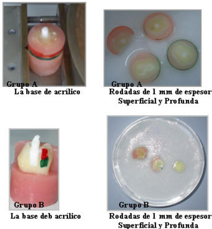
Fig. IV.F.1.-1-Preparación de muestras del Grupo A y B, para el microscopio electrónico de barrido
