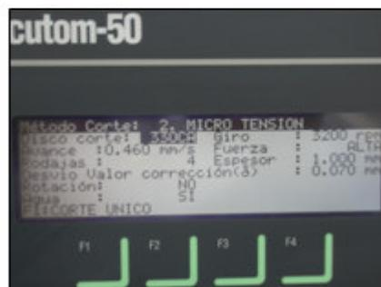
Fig. IV.D.1.-4- Programación de Accutom 50 Struers®
