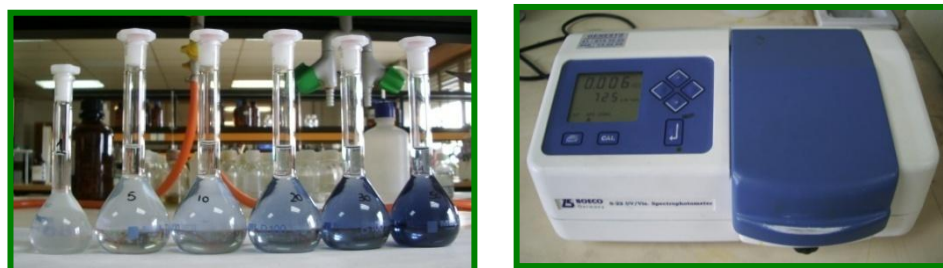
Figura 38. Preparación de la recta de calibrado y lectura de polifenoles totales en espectrofotómetro ultravioleta-visible.
