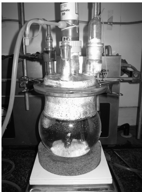
Figura 5.1. Montaje experimental para la ozonización.
