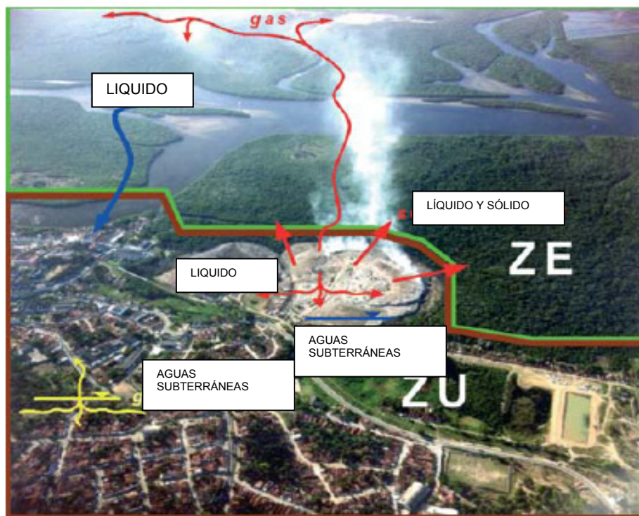
Figura 1.1: Interdependencia entre el vertedero, medio urbano y medio natural (Gandolla y Gfeller, 2005)
