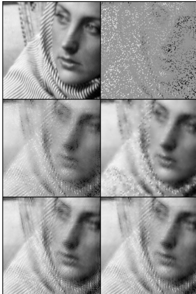
Figura 6.7: Ejemplo visual de interpolación de píxeles perdidos aleatoriamente. Arriba - izquierda, imagen Barbara de nuestro conjunto de prueba recortada a 128 \times 128 . Arriba - derecha, pérdida aleatoria de \approx 80\% de los píxeles rellenados con la media de la imagen (PSNR: 14,75 dB). Centro - izquierda, interpolación conseguida con \ell_1 -GM (23,26 dB). Centro - derecha, resultado de Fast-inpainting (24,84 dB). Abajo - izquierda, resultado de \ell_0 -GM usando Curvelets 6 escalas (25,19 dB) Abajo - derecha, interpolación conseguida con \ell_0 -GM combinando Curvelets 6 escalas con DCT local con tamaño de bloque 32 \times 32 y factores de escala iguales \sqrt{0,5} (25,65 dB).
