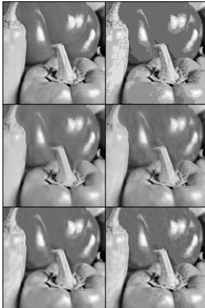
Figura 6.2: Ejemplo de aplicación de \ell_1 -AP y \ell_0 -AP a la eliminación de artefactos de cuantificación espacial. Arriba - izquierda , imagen Peppers original, recortada a 128 \times 128 píxeles. Arriba - derecha , cuantificación con 3 bits observada (PSNR: 28,81 dB). Centro - izquierda , resultado de \ell_1 -AP usando DT-CWT con 8 escalas (29,08 dB). Centro - derecha , resultado de \ell_1 -AP usando Curvelets 6 escalas (29,50 dB). Abajo - izquierda , resultado de \ell_0 -AP usando DT-CWT 8 escalas (31,06 dB). Abajo - derecha , resultado de \ell_0 -AP usando Curvelets 6 escalas (30,85 dB).
