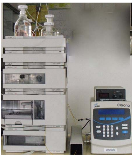
Fig 2.1 Equipo HPLC-CAD utilizado para la caracterización de triglicéridos
