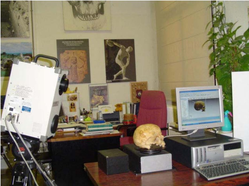
**Figura 32.** Escáner marca *Minolta*. Modelo: *NON-contact 3D Digitizer VIVID-910 VI-910*.
