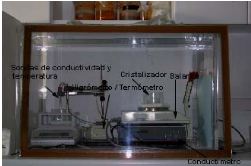
Figura 2.18. Dispositivo experimental para el desarrollo de ensayos de cristalización.
