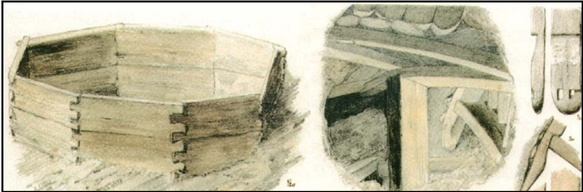
Fig. 417. Dibujo de entibamiento de un pozo romano, El Coto de la Fortuna (Mazarrón) (Antolinos, 2005: 76)
