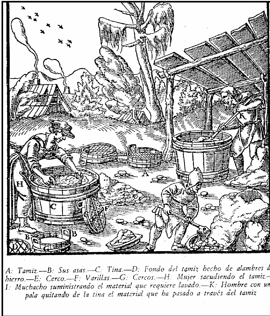
Fig. 485. Representación de los trabajos realizados en el exterior de una mina, en primer plano, una mujer cribando el mineral y un muchacho suministrando el material que requiere lavado (Agrícola, 1556)
