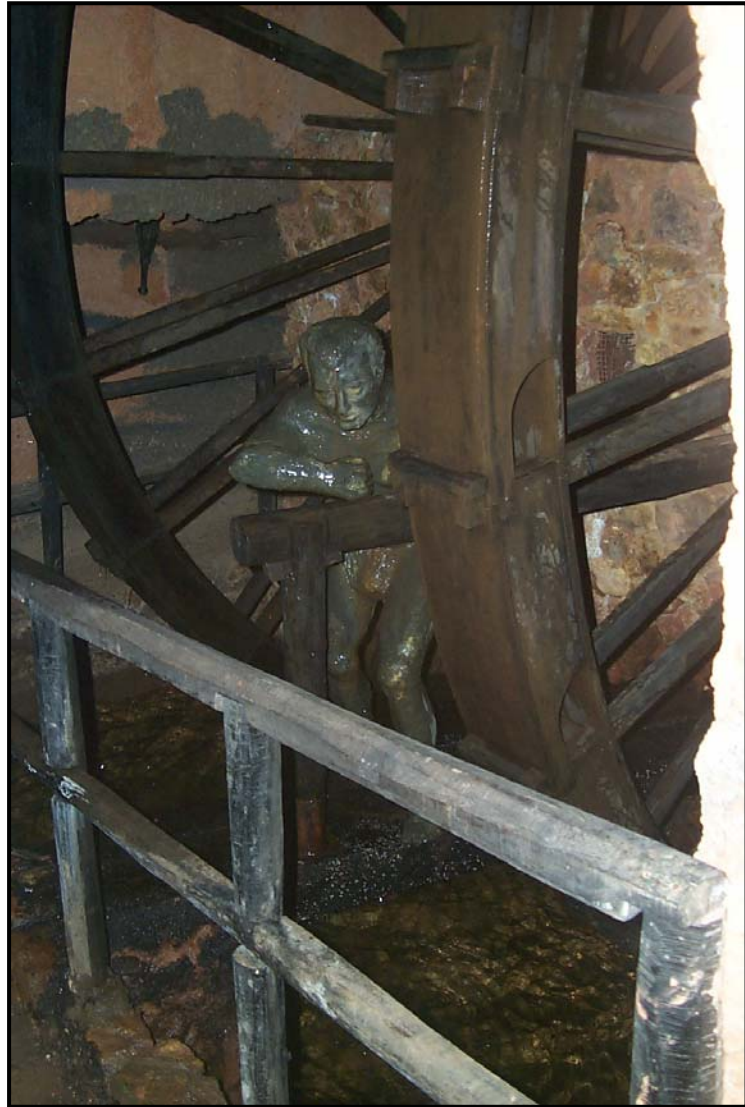
Fig. 456. Foto reproducción del funcionamiento de una noria y la posición que adoptaría el minero (Museo de Riotinto, Huelva)
