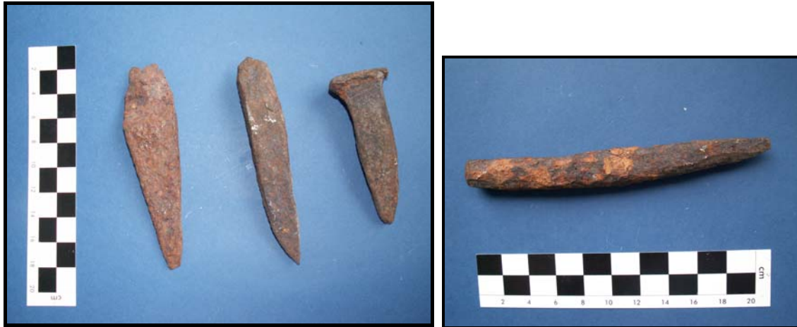
Fig. 428. Punterolas de hierro con diferentes secciones procedentes del pozo Mirador (El Centenillo, Jaén) (Museo Arqueológico de Cástulo, Linares)
