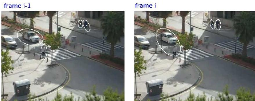
Figura 4.11: Fusión de objetos en el proceso de Detección
